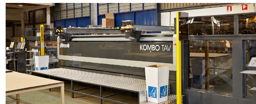
|| La linea di taglio digitale Kombo TAV installata presso Kartox è utilizzata a ciclo continuo per la produzione di pack-on-demand.
